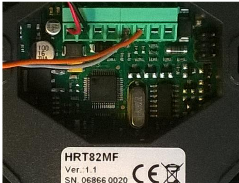
Fig. 2.4. Connessioni CLK-DTA per il lettore HRT82MF
